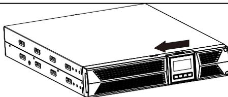
4. Rimuovere il supporto interno destro della batteria.
