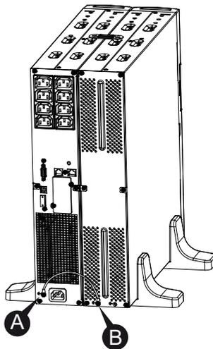
4. Togliere il pannello frontale e collegare il terminale della batteria (A) dall'UPS al terminale EBM (B) come mostrato di seguito. Gli utenti devono rimuovere il piccolo cancello (C) sul lato del pannello frontale per consentire al filo di uscita dell'EBM di passare attraverso il cancello e quindi rimontare il pannello frontale.
