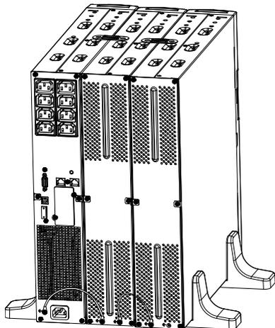
2. Togliere il pannello frontale e collegare il terminale della batteria (A) dall'UPS al terminale EBM (B) come mostrato di seguito. E poi collegare il terminale della batteria (D) dal primo EBM al terminale della batteria (E) dal secondo EBM. Gli utenti devono rimuovere il piccolo cancello (C) sul lato del pannello frontale per consentire al filo di uscita dell'EBM di passare attraverso il cancello e quindi rimontare il pannello frontale.
