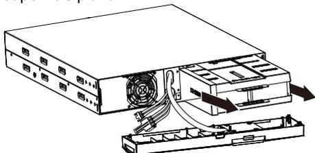
6. Installare un nuovo pacco batteria nell'UPS.
