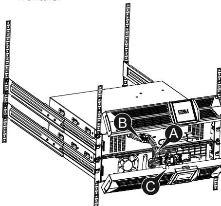
5. Dopo aver installato l'UPS nel rack, il carico può essere collegato all'UPS. Accertarsi che l'attrezzatura di carico sia spenta prima di inserire tutti i carichi nella presa di uscita.
